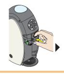
レバーを押し上げて、撹拌部を ロックします。
